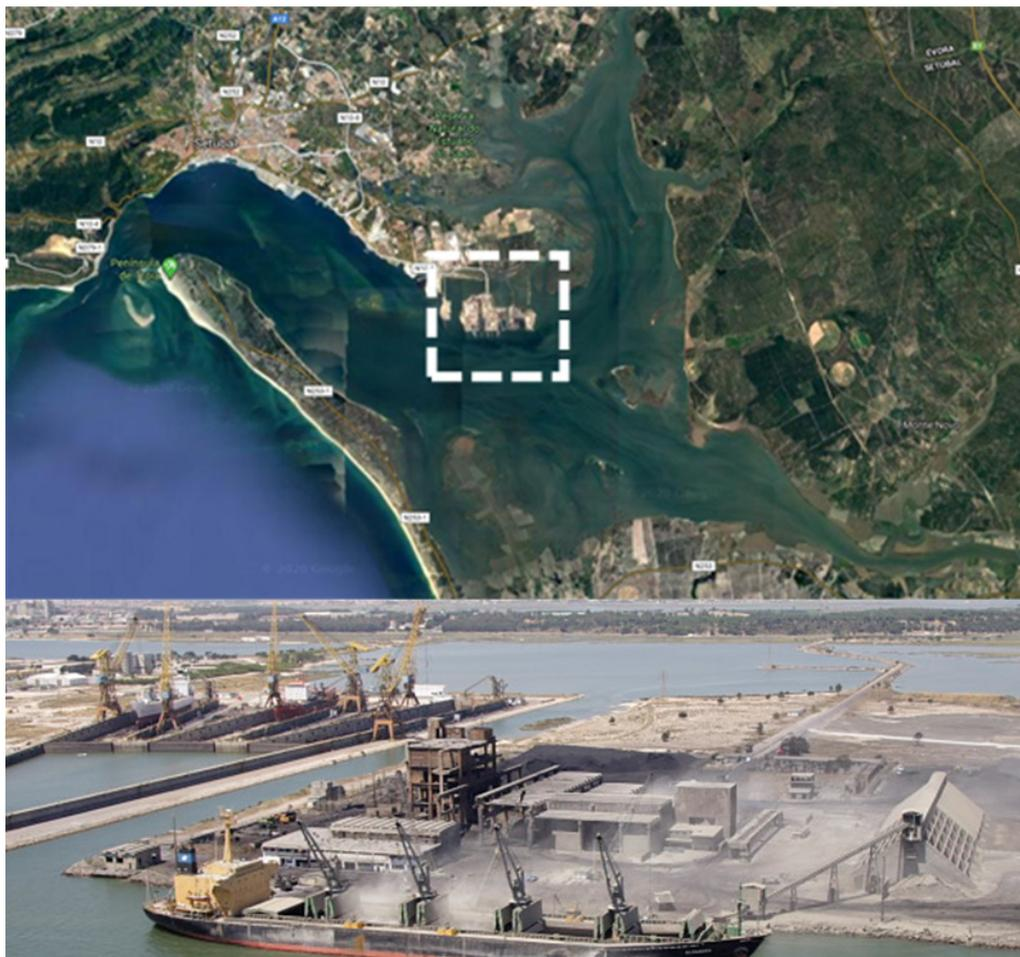
Figura 1. Localização do cais da Teposert. Um cais de 152 m de comprimento (1 posto de atracação), que permite a atracação de navios até 200 m de comprimento, até 10 m de calado (fonte: <https://www.portodesetubal.pt/>).
