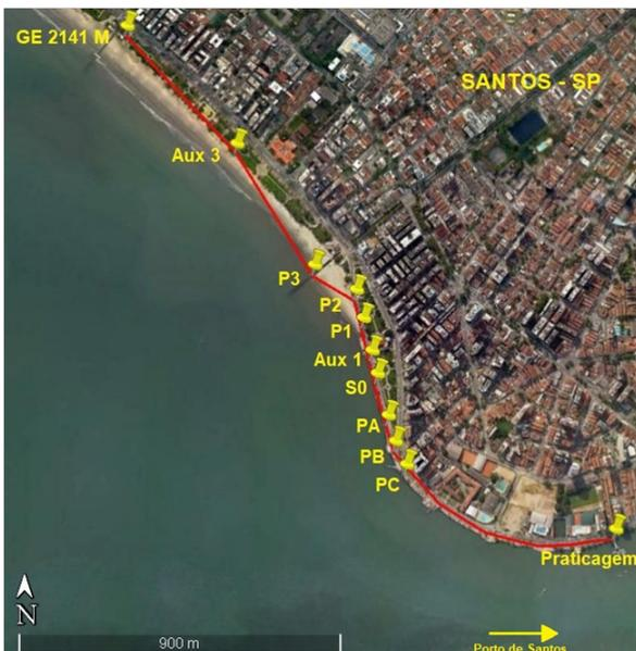
Figura 4: Localização dos pontos e poligonal do nivelamento geométrico.
