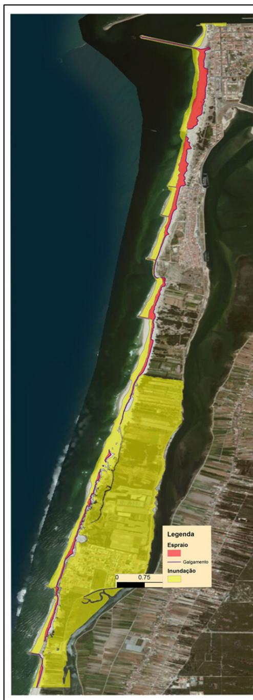
Figura 2 - Mapa do risco de galgamento, espraio e inundação no trecho Barra-Vagueira em 2100 em cenário de alterações climáticas B1 com 0,62 m de subida de nível médio do mar em 2100 e agitação marítima com sobreelevação meteorológica com período de retorno de 100 anos (forçamento intermédio), desenvolvido no projeto CHANGE. (Fonte: Vargas e Santos, 2013).
